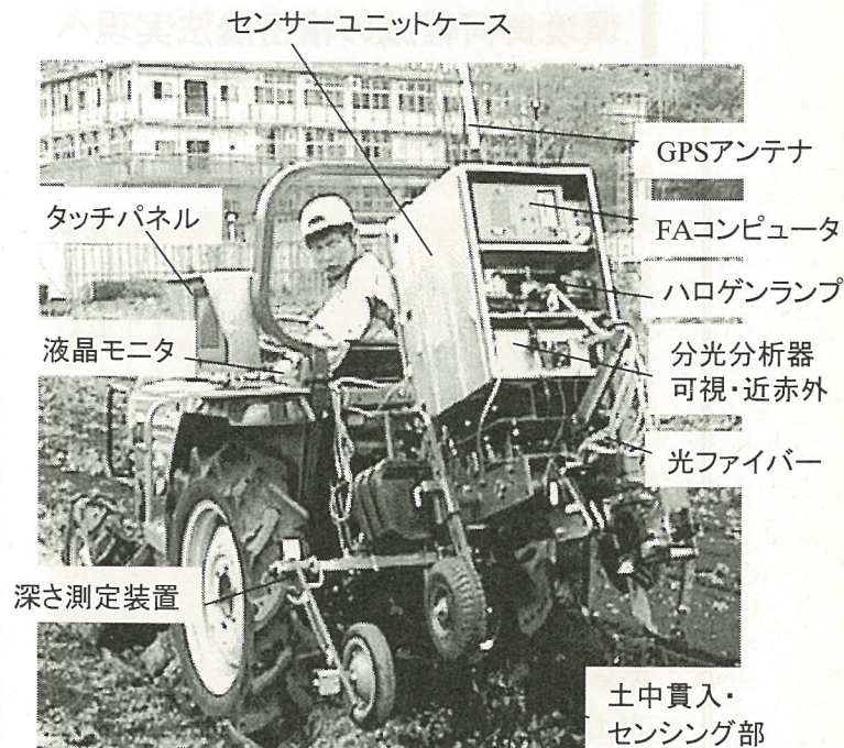
図2 リアルタイム土中光センサー
