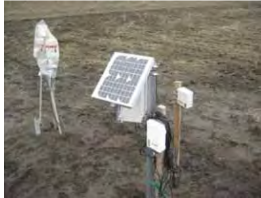
フィールドルーター
