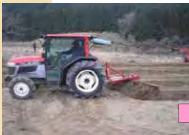
堆積層のリアグレーダによる除去
