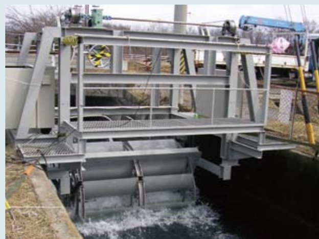
民間企業と共同開発した流水利用型小水力発電装置
