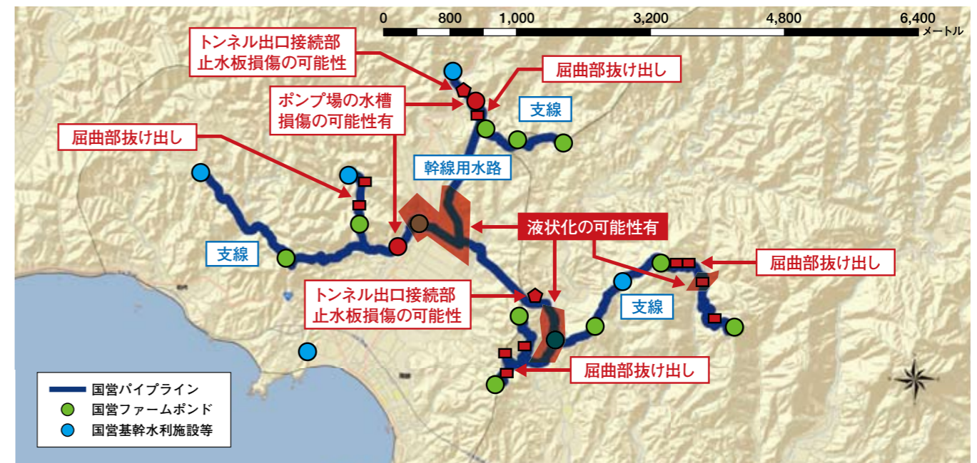
農業水利施設の耐震性能概略評価結果(南紀用水地区)
